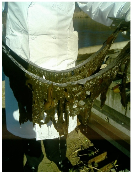
図. (左上) 水質浄化用炭素繊維材料。(右上) 微生物と汚泥が付着した炭素繊維織物。 (左下) 河川に設置された炭素繊維。(右下) 炭素繊維および付着した汚泥。
